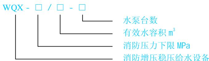
举例：WQX 0.18/0.45-2 表示该设备的消防压力下限是 0.18MPa，有效水容积是 0.45 m<sup>3</sup>，稳压水泵 2 台。
